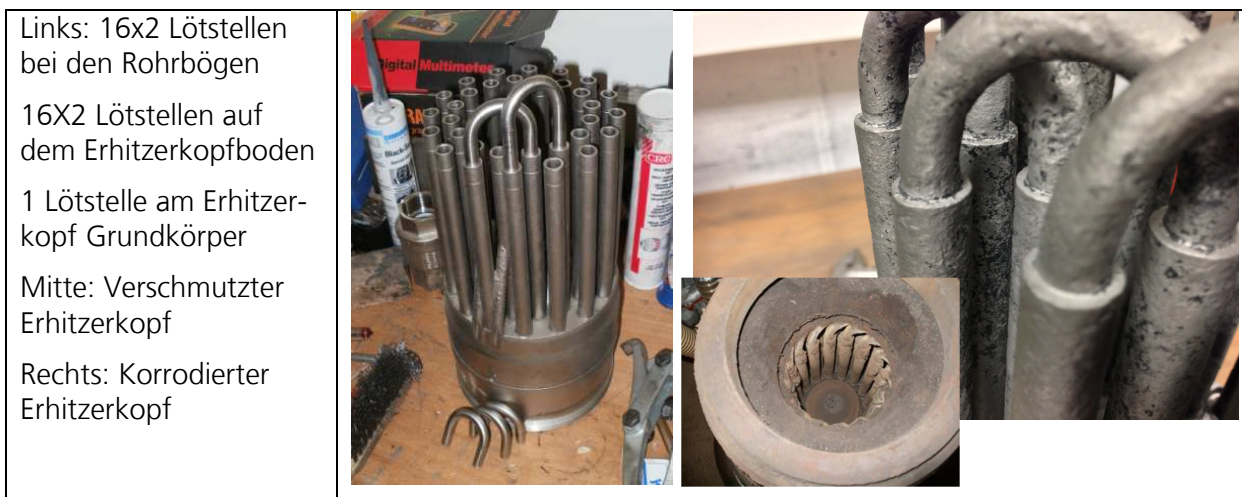
Abbildung 1: Mehrteiliger Rohrbündelerhitzerkopf der Sunmachine I aus Edelstahl mit Silberlotverbinder.
