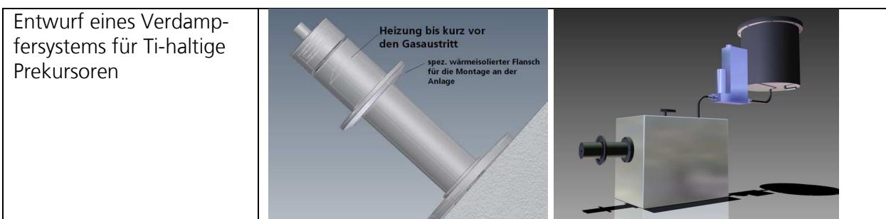
Abbildung 5: Prototyp eines Verdampfersystems für Ti- haltige Precursor- Gase.
