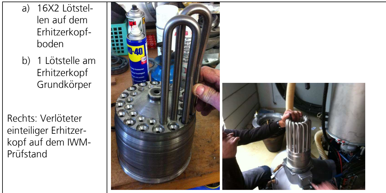
Abbildung 2: Entwurf eines einteiligen Erhitzerkopfs.
